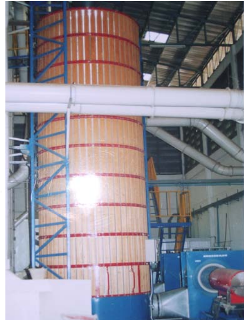
รูปที่16 โครงสร้างเครื่องอบเมล็ดแบบถังคอกัดมันเมล็ดอยู่กับที่ (Bin drier)
