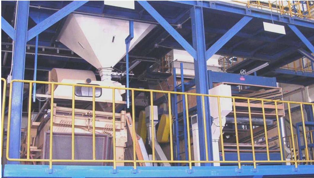
รูปที่18 เครื่องทำความสะอาดและคัดขนาดเมล็ด ขนาดใหญ่(ขาว) และเครื่องคัดเมล็ดโดยน้ำหนัก(ซ้าย)
