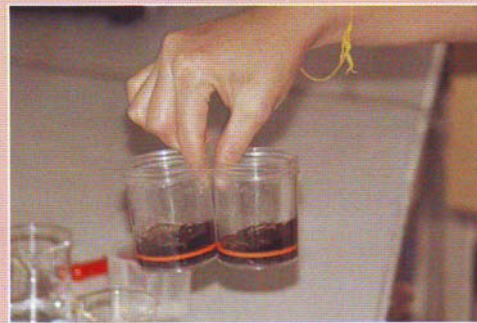
เติมสารละลายสำหรับย้อมสี แกว่ง 45 วินาที
