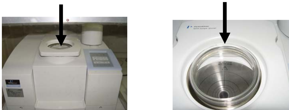
ภาพที่ 5 เครื่อง Near Infrared Spectroscopy ระบบ FTIR มีที่ใส่ตัวอย่างแบบจานหมุน ที่มา: Perkin Elmer
