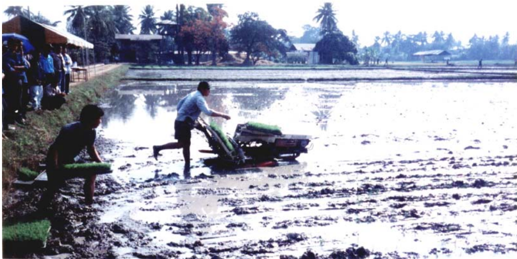
ภาพที่ 9 การใช้เครื่องปักดำข้าวจาปอนิกา
